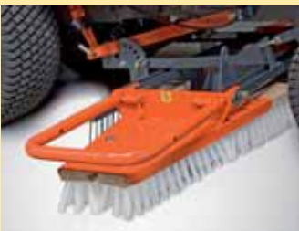
Щётки регулируются по ширине для процесса очистки (2.000 мм) или для процесса ухода (2.400 мм)
