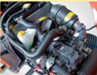
2-цилиндровый бензиновый мотор, водяного охлаждения, 26 л.с.
