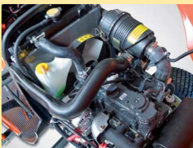
3-цилиндровый дизельный мотор, водяное охлаждение, 21 л.с.
